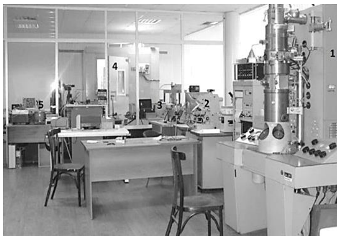
Рис. 1. Комплекс лабораторной аппаратуры, где проводился синтез нанотрубок оксида цинка: 1 – электронный микроскоп ЭММА-4; 2 – оптический микроскоп МБИ-15; 3 – вакуумная установка; 4 – большая облачная камера; 5 – оптический микроскоп Motic / Fig. 1. Complex laboratory equipment, which carried out the synthesis of nanotubes of zinc oxide: 1 - electron microscope EMMA-4; 2 - optical microscope MBI-15; 3 - vacuum; 4 - a large cloud chamber; 5 - optical microscope Motic
